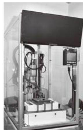
ねじ締めロボットのデモ機
